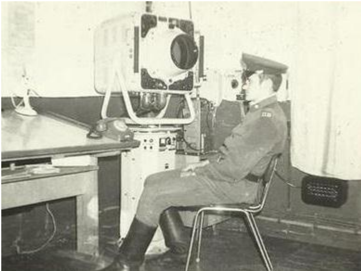
Foto 5. Ramsi TVP vana operaatorihoone sisevaade – radar Don (TVP-I oli neid 2) ja planšetilaud, akna all kalorifeer. Foto valdaja Кривец (teenistusaeg Paslepa kordonis 02.1976– 05.1977), http://www.pogranec.ru/showthread.php?t=29576&page=13 .
