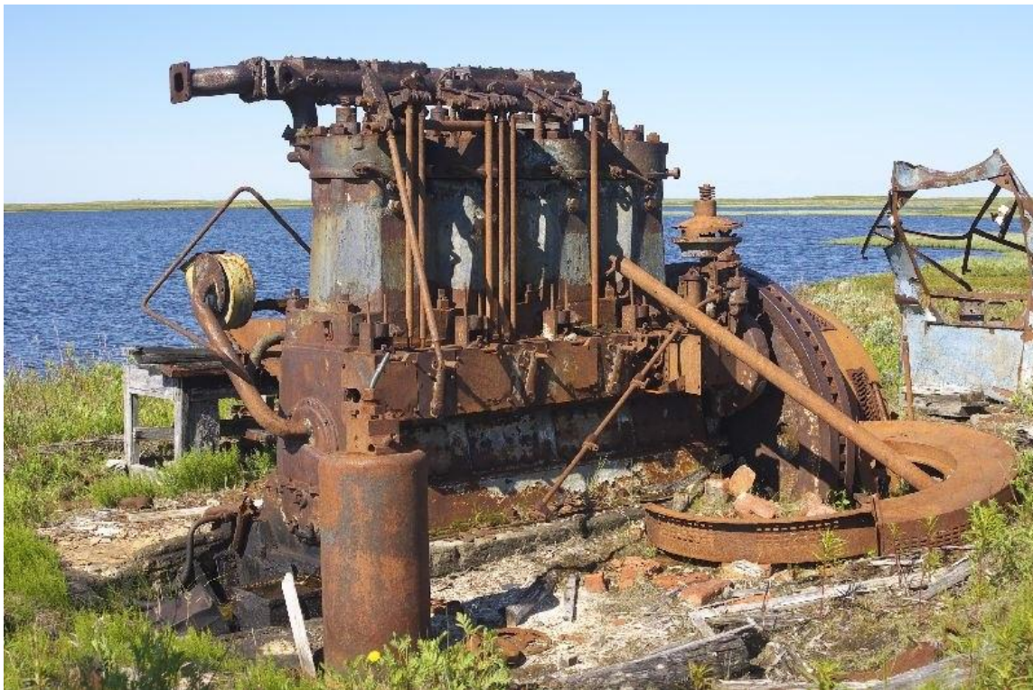
Foto 2A. Diiselagregaat Moržovetsi saarel Zolotušnoje järve ääres 2015.a suvel (sellel Valge mere saarel oli 180 mm-ne tornpatarei). Nii silindriplokk kui hooratas on väga sarnased Ninase jõujaama diislite omadega. Allikas: https://vk.com/wall-63510764_392?z=photo-63510764_359111613%2Falbum-63510764_00%2Frev .
